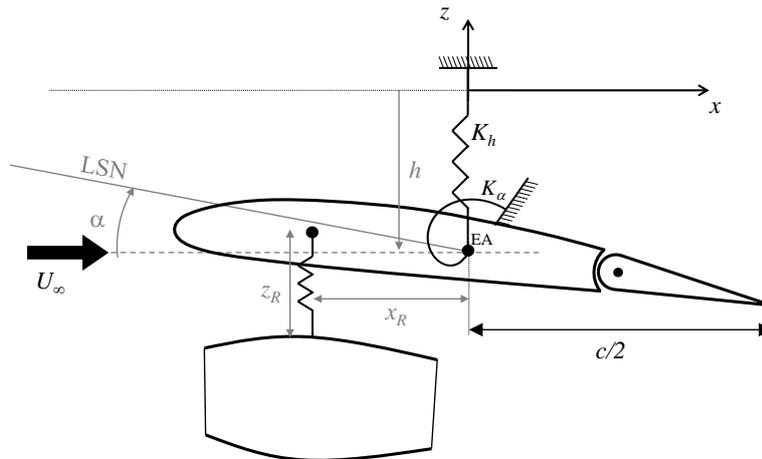
Figura 1: Sección típica con motor de masa  $M_R$
